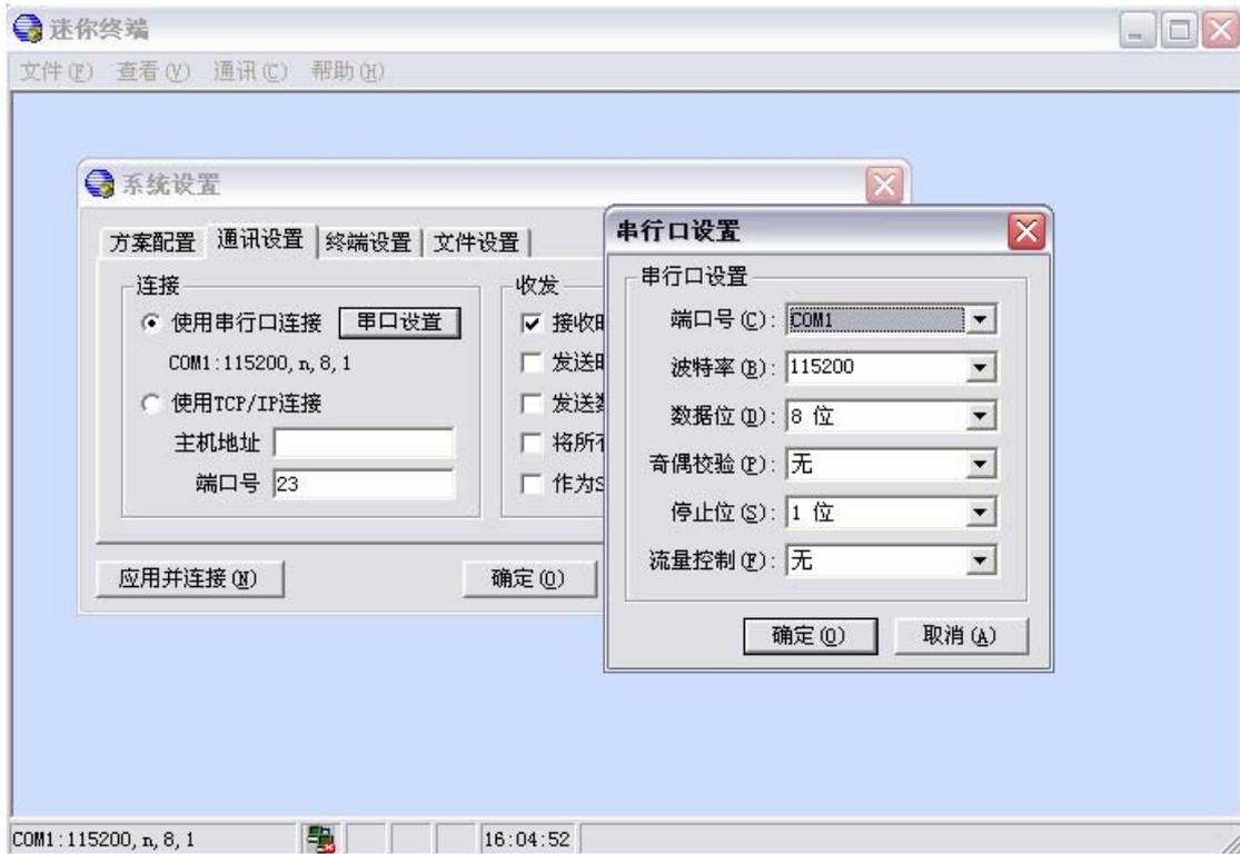
2、点击工具条上的[通讯] → [建立连接]按钮建立连接:
