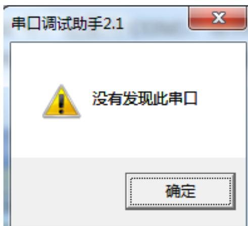
表示默认的 PC 机的 COM 口被终端占用了，关闭被占用的终端，然后再串口调试工具。
